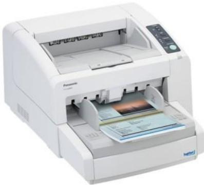
Der Scanner verfügt über einen Papiereinzug, der die Papierbeschaffenheit der Vorlage erkennt und den Druck der Walzen entsprechend anpasst. Dies ermöglicht das Einscannen von Vorlagen unterschiedlichen Papiergewichts, von Vorlagen mit sehr dünnem Papier (20 g/m<sup>2</sup>) bis hin zu sehr dickem Papier (209 g/m<sup>2</sup>).
